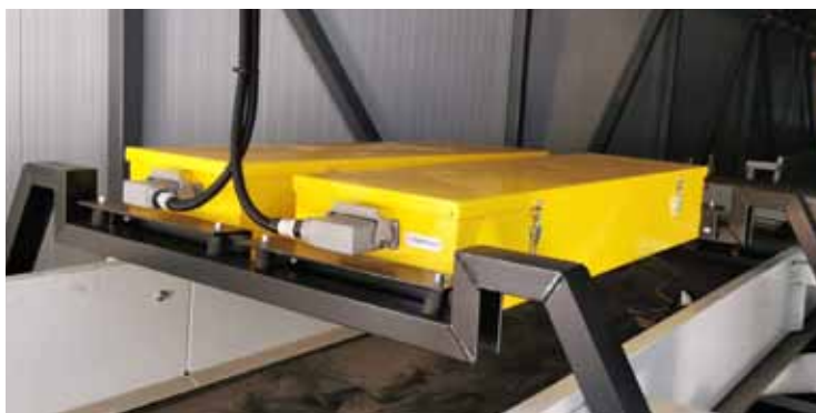
System PI-MSKA montowany nad podajnikami taśmociągowymi
